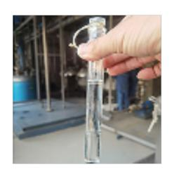
LQ-TBEC叔丁基过氧化碳酸-2-乙基己酯商品名称□LQ-TBEC化学名称: 叔丁基过氧化碳酸-2-乙基己酯英文名称□Tert-butylperoxy-2-ethylhexylcarbonate化学结构式: 技术标准: 分子量: 246.3理论活性氧含量□6.05%CAS□34443-12-4Einecs□252-029-5外观: 无色清亮液体含量: ≥98.5%色度:
